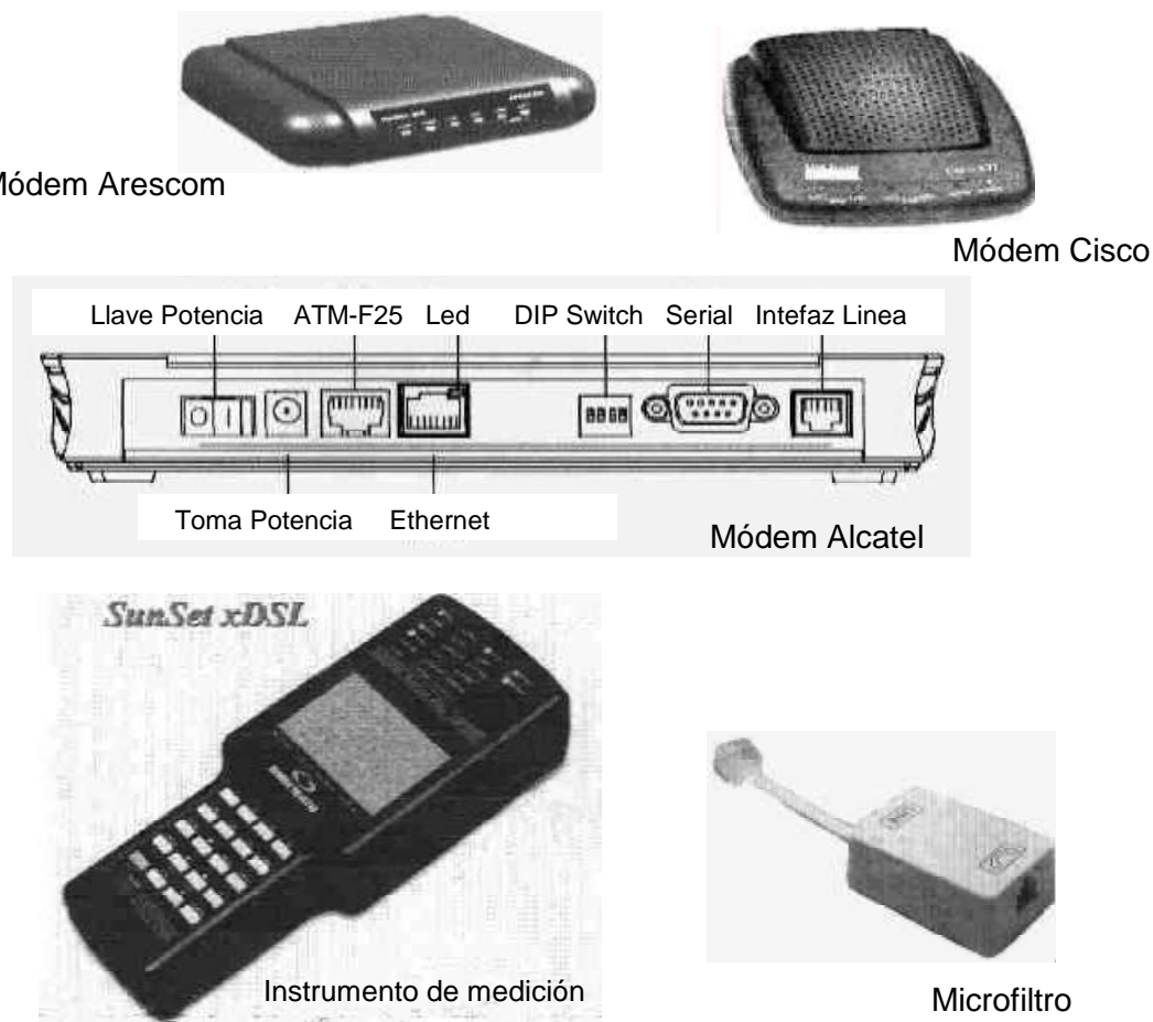
Fig. 48 - Dispositivos de la red interna del abonado
